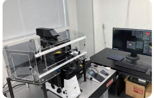
ニコンの超解像顕微鏡[N-SIM S/N-STORM]は、最速15fpsの高速画像取得が可能な構造化照明顕微鏡法および水平解像度20 nm・Z軸方向解像度50 nmに達する高精細の確率論的再構築光学顕微鏡法を1台のシステムとして統合しており、様々な超解像イメージング用途に対応できます。温度変化や振動の影響を高精度に補正する自動焦点維持装置と、ワンクリックで球面収差を補正する電動補正環付き対物レンズが、ナノスケールの撮影をサポートします。
