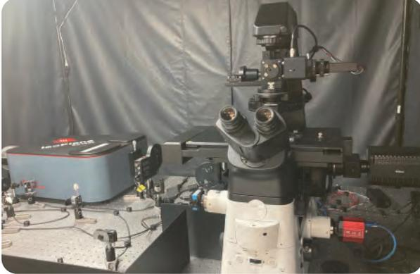
ラマン顕微鏡は、試料中の分子情報 (分子振動) を反映したラマンスペクトルを計測する光学顕微鏡です。試料は、固定・無固定を問わず、細胞、組織切片、摘出組織等、顕微鏡に静置できるものであれば測定可能です。当拠点のラマン顕微鏡は、532 nmレーザー (今後、他の波長も追加予定) を採用しています。また、LED光源による蛍光イメージング、785 nmフェムト秒レーザーによる多光子観察なども同時に実施可能です。
